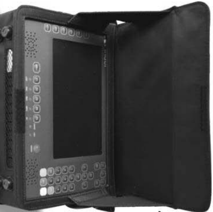
Настройка козырька для получения оптимального затенения
