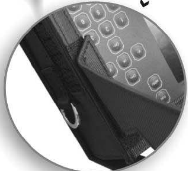
Настройка козырька для получения оптимального затенения
